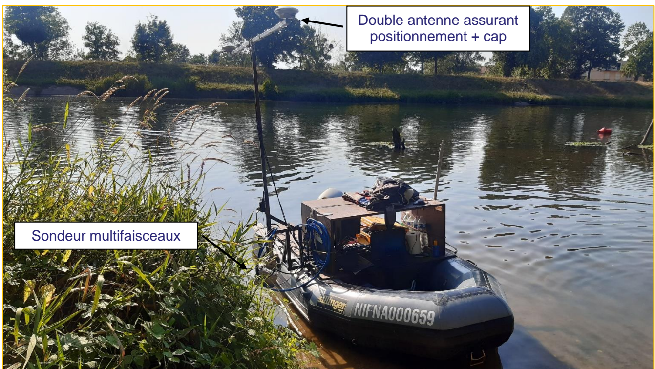
Illustration 6 : embarcation pneumatique Sillinger 380UM avec la chaîne d'acquisition multifaisceaux.
